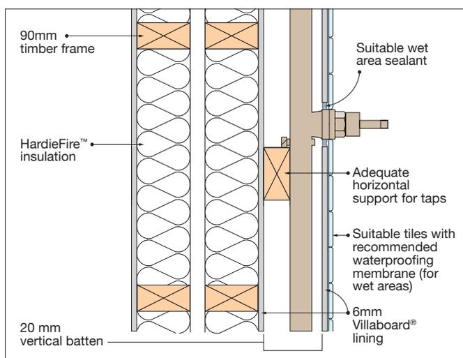
FIGURE 8 HARDIESMART™ AGED CARE WALL SYSTEM PLUMBING PIPE PENETRATION - SECTION
