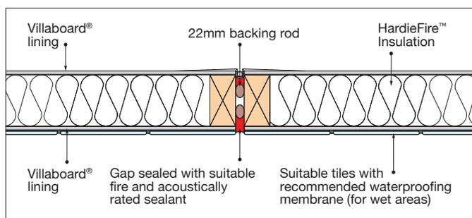
FIGURE 5 HARDIESMART™ AGED CARE WALL SYSTEM - VILLABOARD® LINING CONTROL JOINT
