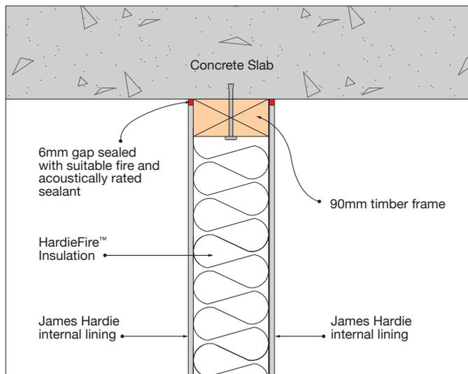
FIGURE 3 HARDIESMART™ AGED CARE WALL SYSTEM HEAD TO SLAB
