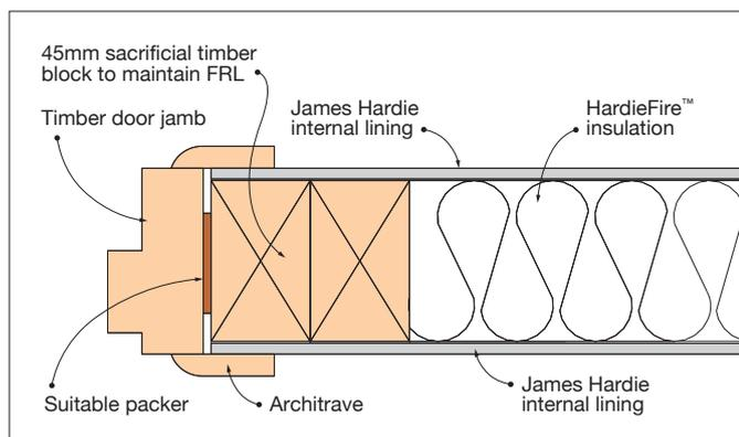
FIGURE 6 HARDIESMART™ AGED CARE WALL SYSTEM TIMBER DOOR JAMB
