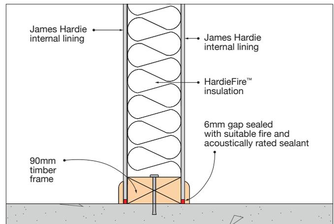
FIGURE 2 HARDIESMART™ AGED CARE WALL SYSTEM BASE TO SLAB
